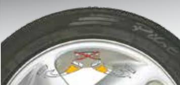
Parfaite esthétique de la jante parce qu'elle permet de diviser la masse d'équilibrage adhésive du flanc extérieur en deux masses équivalentes placées dans une position cachée derrière les rayons.
